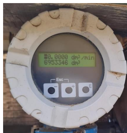
(29/12) Relevé débitmètre lixiviats D2 comptant pour le bilan du mois de décembre 2023
