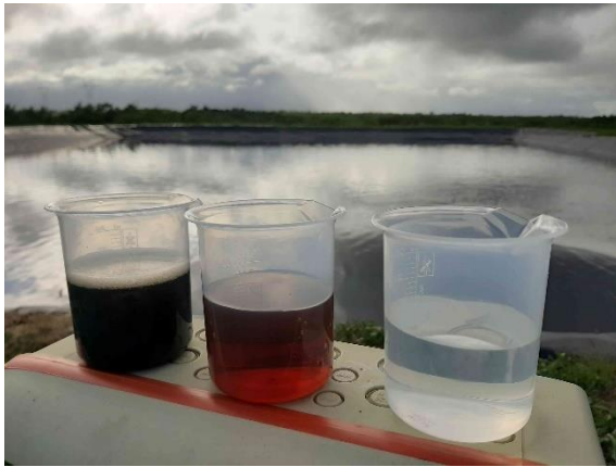
Lixiviats bruts → biodégradés ultrafiltrés → nanofiltrés
