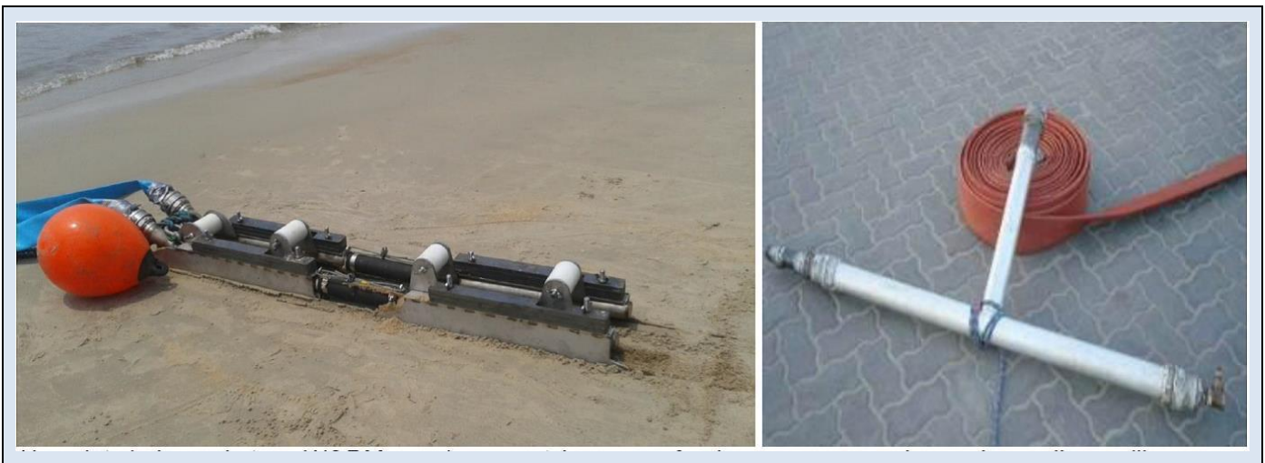
Figure 20 : Trencher "jet sledge et lance à eau d'ensouillage
