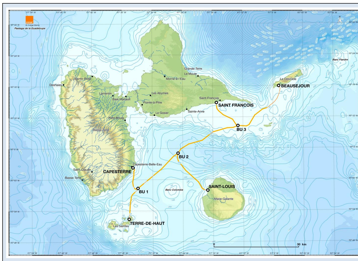
Figure 1 : Tracé global du câble sous-marin de Guadeloupe
