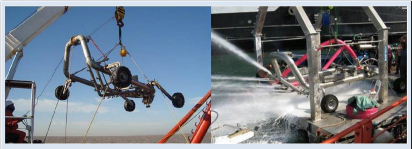
Figure 19 : Trencher de type "jet sledge" pour ensouillage des câbles
