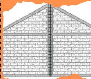
**Recouvrement angulaire et chaînage d'angle :** configurations dites en « angle avec équerres » et en « angle avec boucles ».
